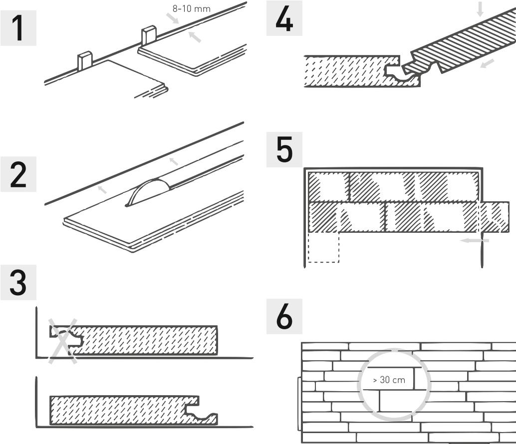
Начните укладку первого ряда панелей с дальнего левого угла помещения. Укладывайте так, чтобы обе стороны панели с гребнем были обращены к стене.
