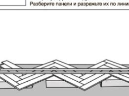
12. Соедините отрезанные начальные панели так, чтобы получились треугольники. Установите их вдоль стены, от которой начнете укладку, друг за другом. Начните установку с левого угла.
