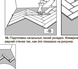
10. Подготовка начальных линий укладки. Измерьте, отметьте и разрежьте собранные четыре ряда параллельно передней стенке так, как это показано на рисунке.
