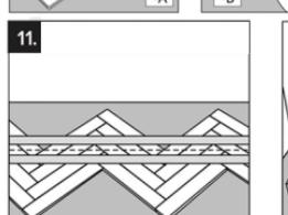
11. Пронумеруйте каждую панель. Это позволит вам сохранить порядок панелей при дальнейшей сборке. Разберите панели и разрежьте их по линии, отмеченной в предыдущем пункте.
