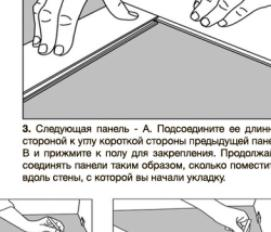
3. Следующая панель - А. Подсвдините ее длинной стороной к улу короткой стороны предыдущей панели В и прижмите к полу для закрепления. Продолжайте соединять панели таким образом, сколько поместится вдоль стены, с которой вы начали укладку.
