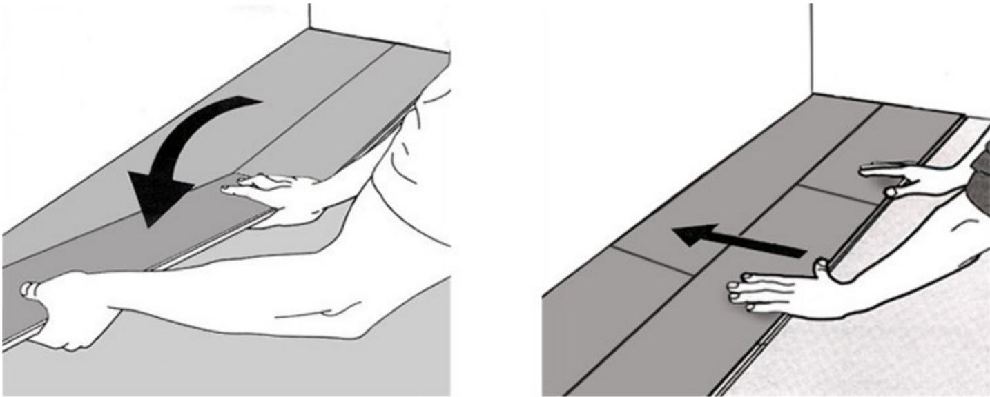
Далее производится установка плитки в торцевой замок и соединение с первым рядом. Для прочного соединения допускается подбить ладонью плитку.
